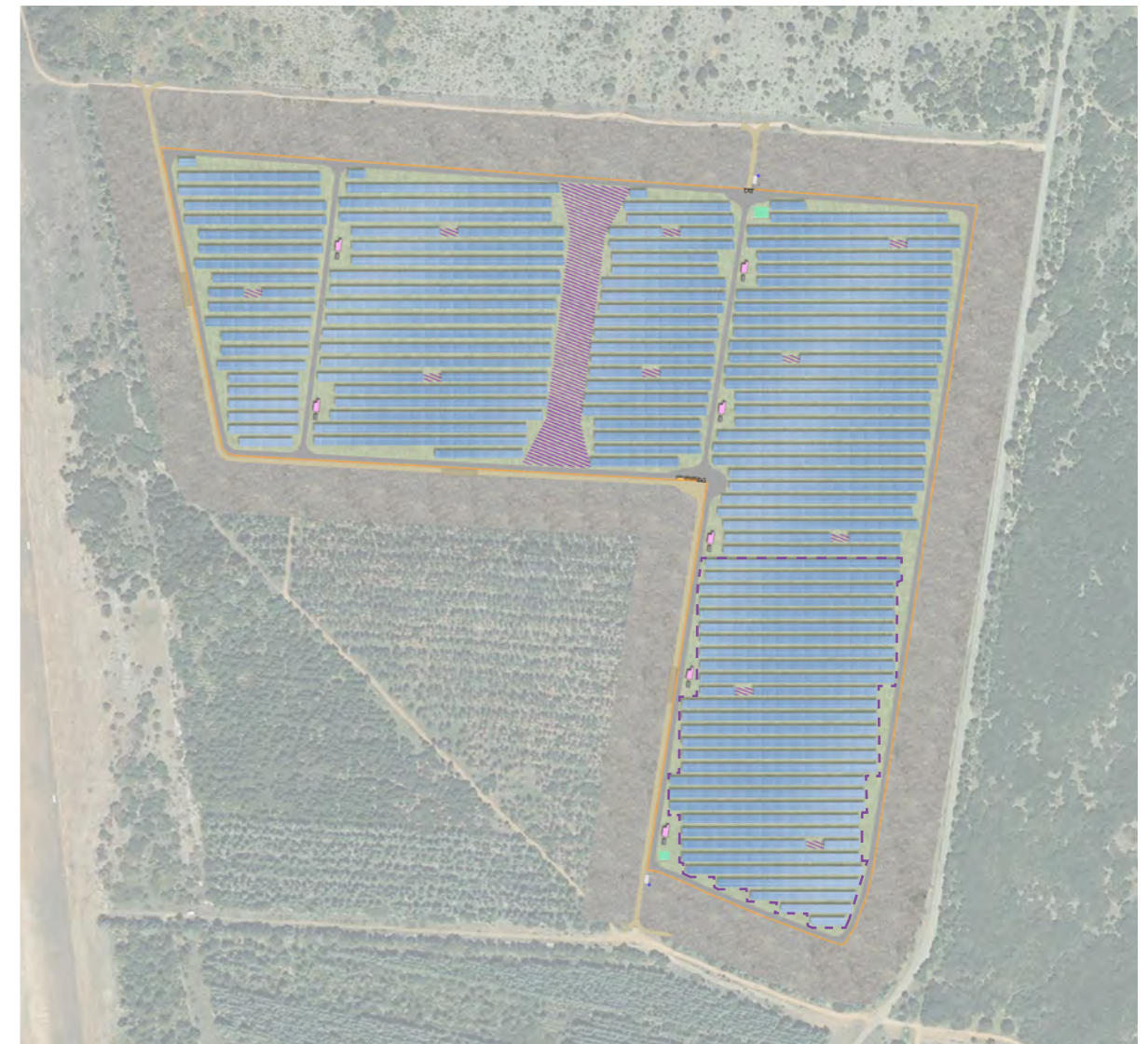
Localisation de la zone avec une surélévation des tables de 0,40 m
