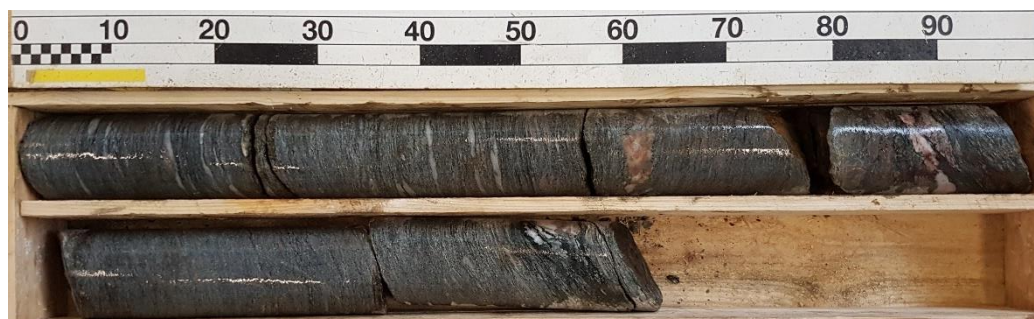
Figure 6 : Gneiss SW (SC9 de 11,50 à 13,00 m/TN)
