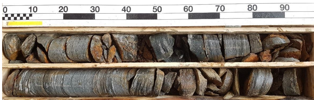
Figure 5 : Gneiss MW avec des passées HW (SC9 de 5,50 à 7,50 m/TN)
