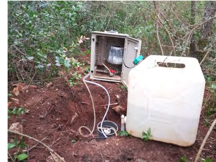
Photographie du perméamètre à simple anneau utilisé pour réaliser les essais (essai EI01)
