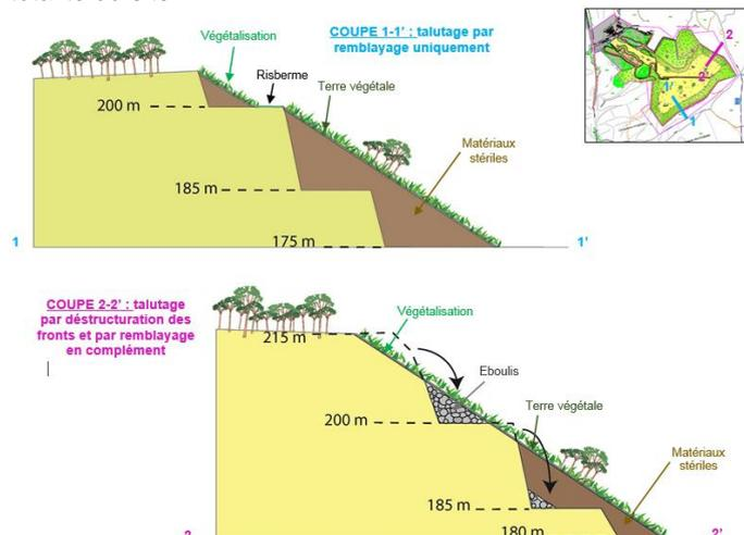
Schéma présentant les deux types de talutage des fronts : par remblayage uniquement (en haut) et par éboulement partiel des fronts (en bas)
