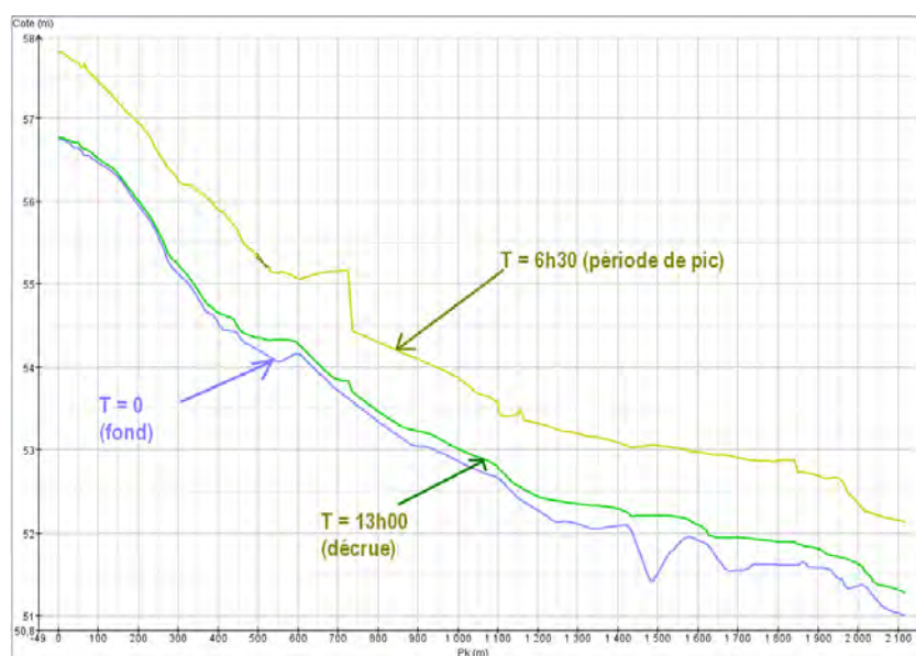
Figure G-10 : Lignes d'eau à l'état initial, à T=6h30 (pic de crue) et à T=13h00 (décrue).
