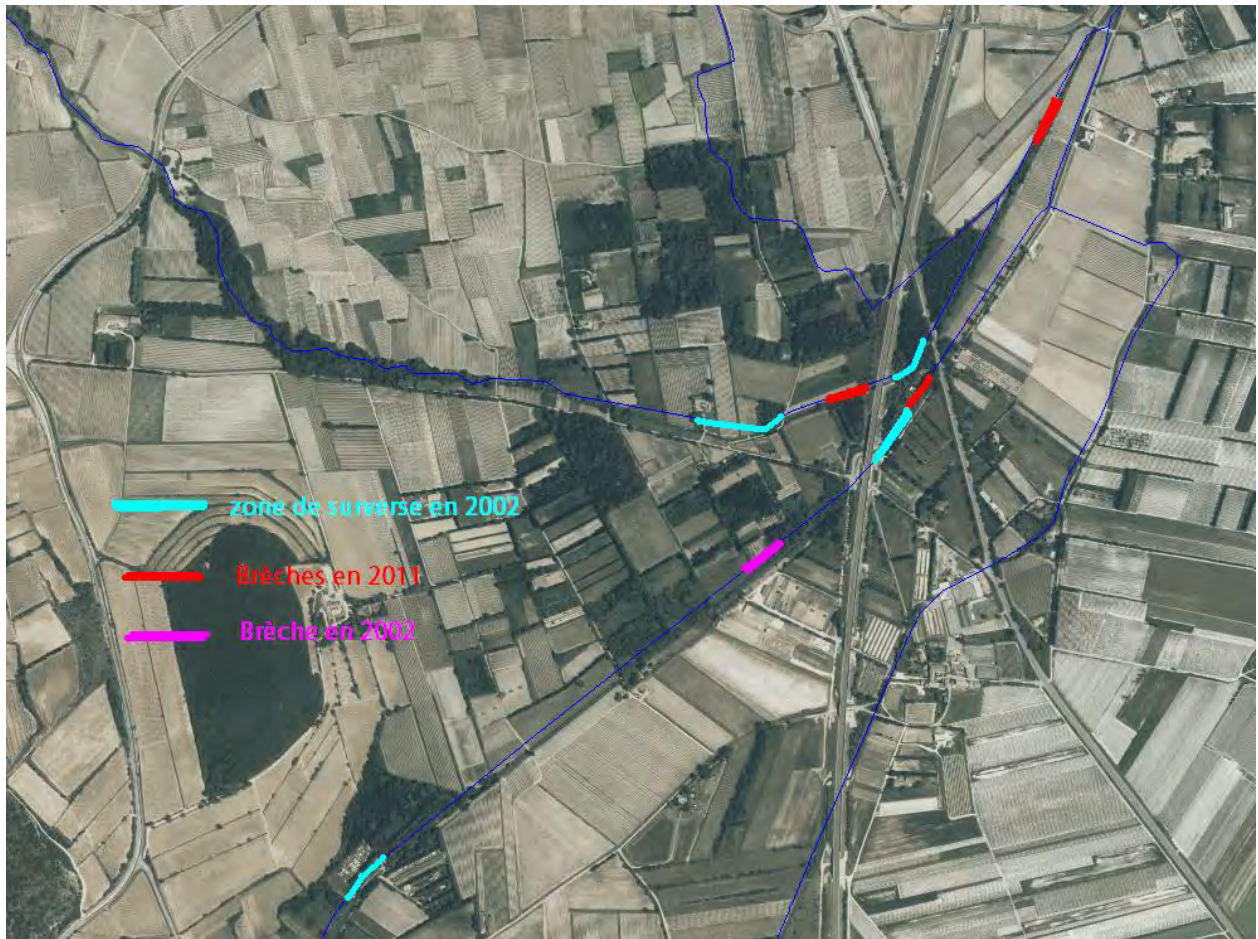
Figure B-2 : Ruptures de digue et surverse lors des événements de 2002 et de 2011
