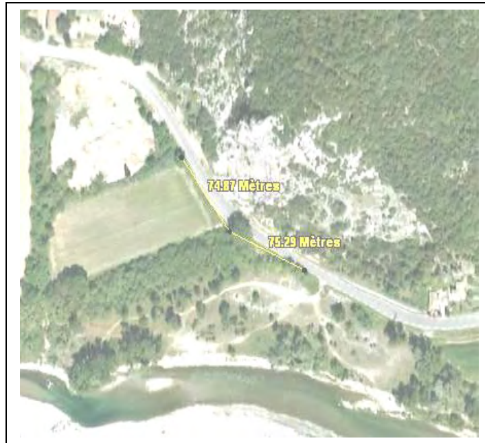
Figure 7 : localisation et extension des barrières de protection anti-renversement en bordure de route)
