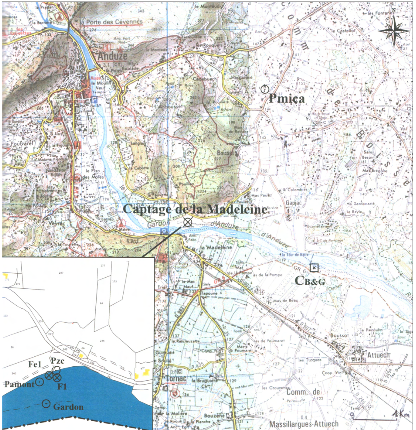
Figure 3 : localisation des forages Fe1 et F1 et des piézomètres (Pzamont, Pzc, Pmica)
