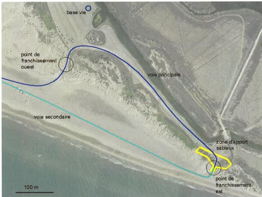
Vue rapprochée ; points de franchissement du cordon dunaire et emplacement possible d'une base vie (source : OrthoExpress OpenIG 2018)
