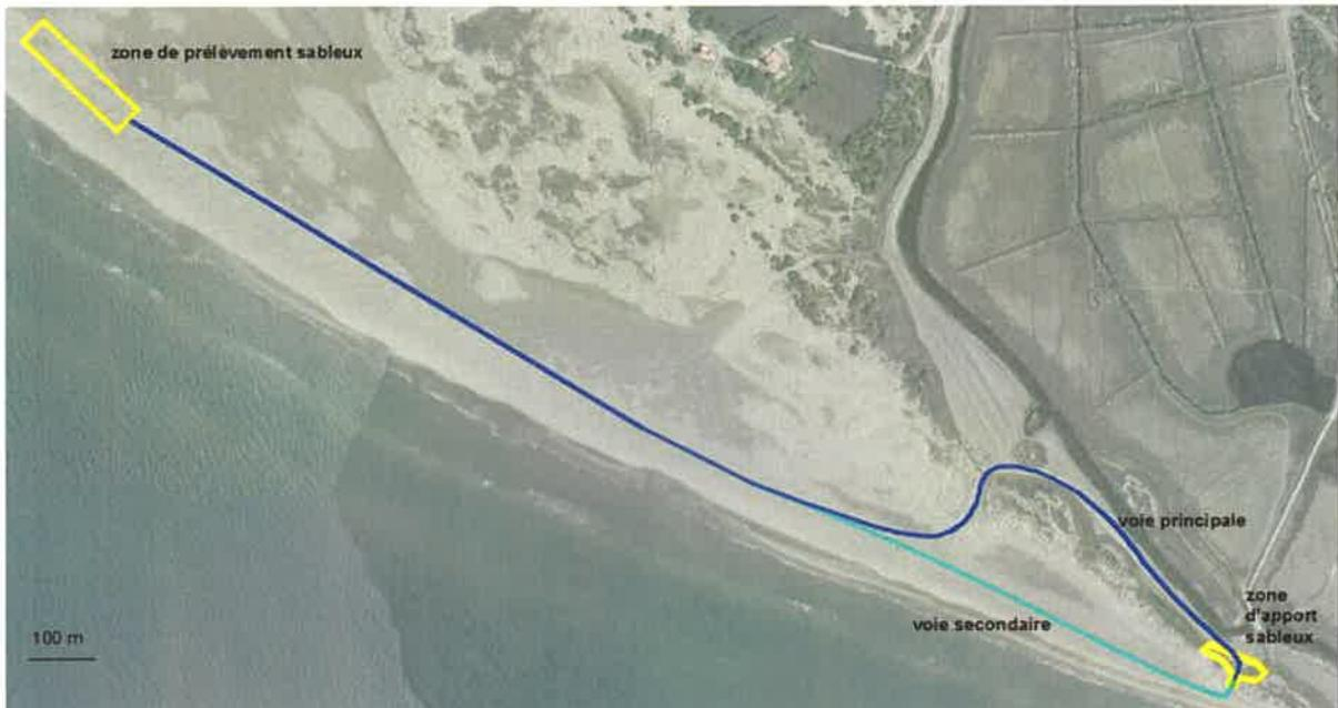
Schéma de principe de circulation entre les zones de prélèvement et d'apport sableux (source : OrthoExpress OpenIG 2018)
