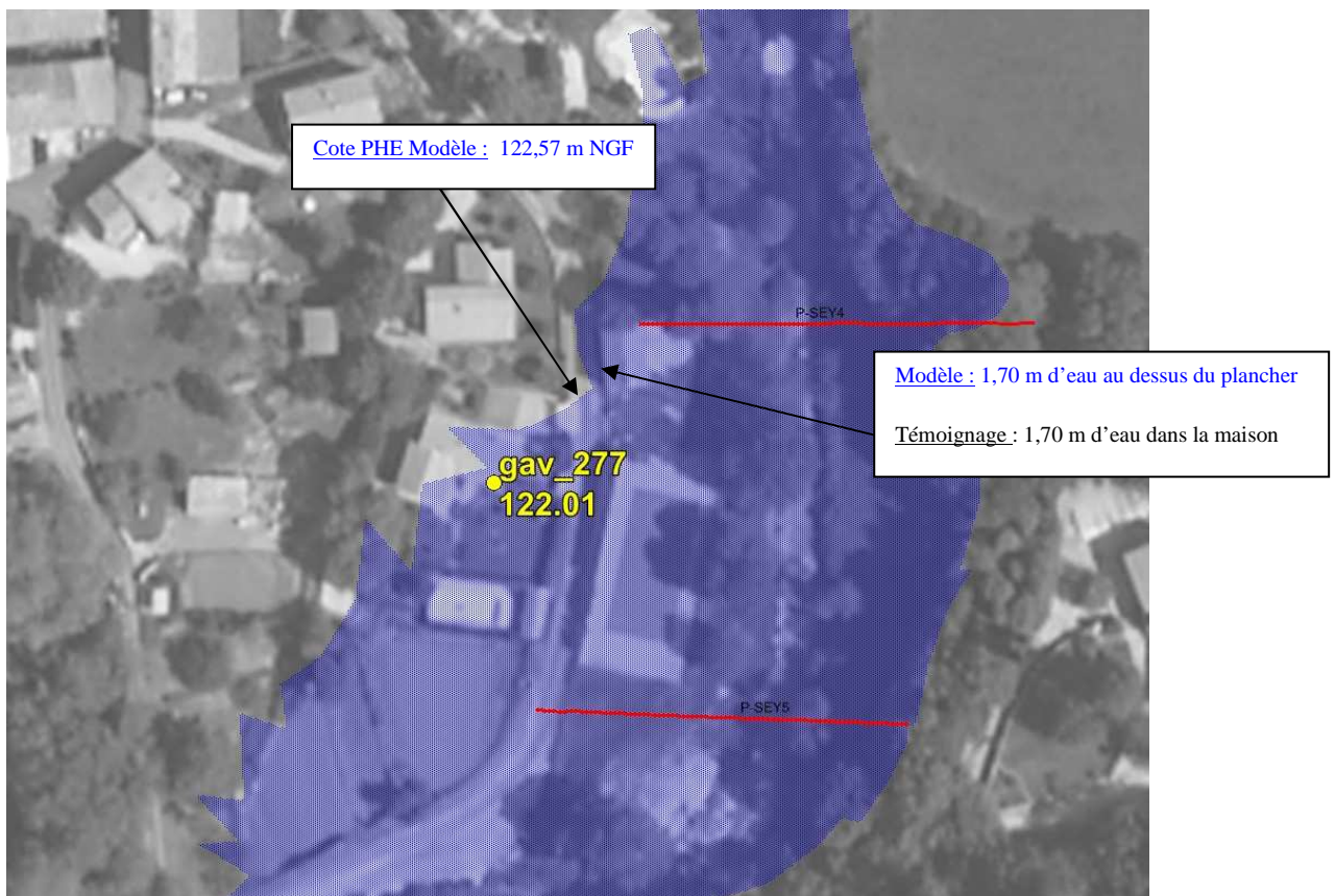
Figure 30 : Résultats du calage du modèle sur la crue de 2002, au droit de Labaume
