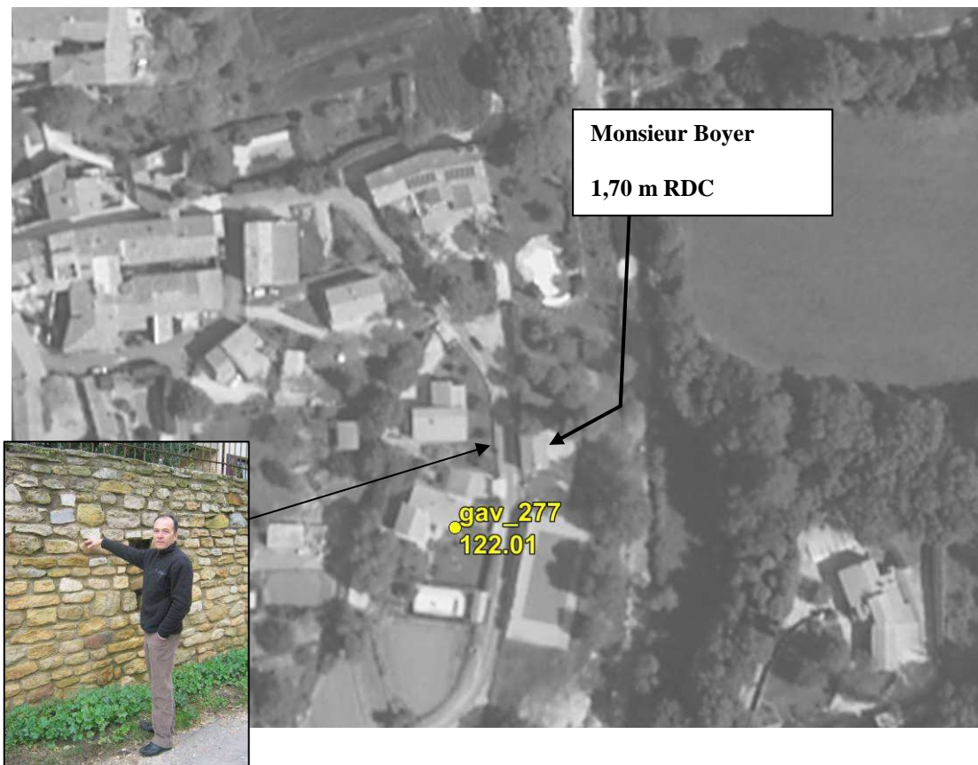
Figure 26 : PHE nivelée et témoignages des niveaux de la crue de septembre 2002 au droit de Labaume
