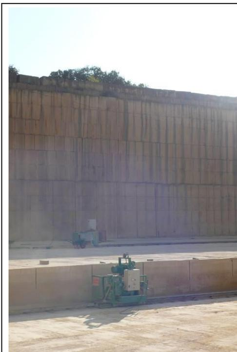
Haveuses à découpe horizontale et verticale en fonctionnement simultané
