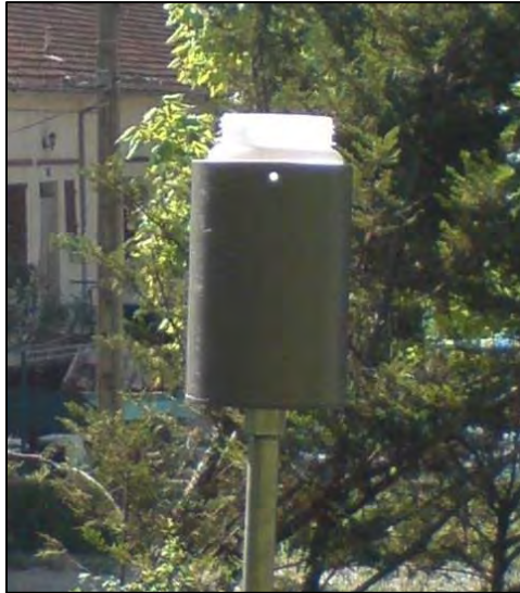
Photographie 9 : Collecteur en PEHD 21 pour les métaux (source : rapport INERIS DRC-18-162397-00395A)
