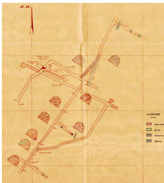
1945, mine de Pallières, puits n° 1, plan des travaux (arch. DREAL 6.2.10, CDP-p-037)
