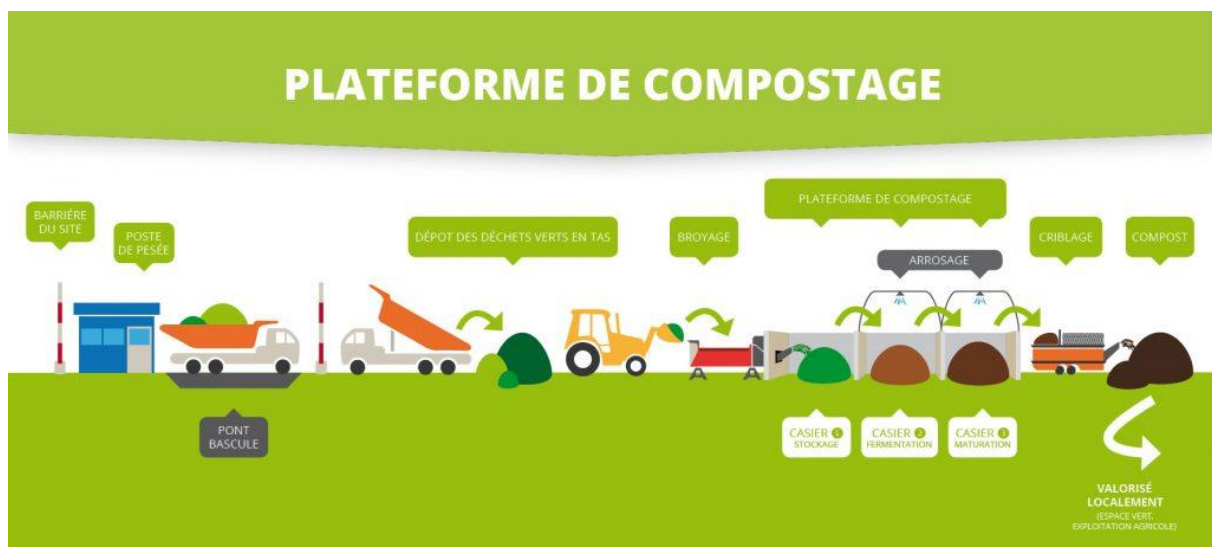
Image 5 : Schéma de fonctionnement d’une plateforme de compostage de déchets verts
