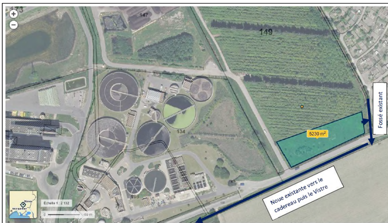
Figure 56 - Intégration du volume de compensation de la STEU
