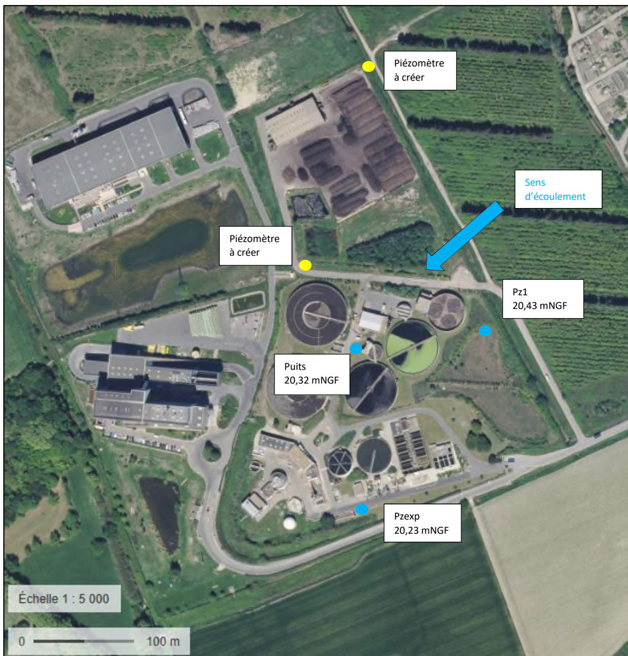
Figure 47 - Complément du réseau de surveillance de la qualité des eaux souterraines
