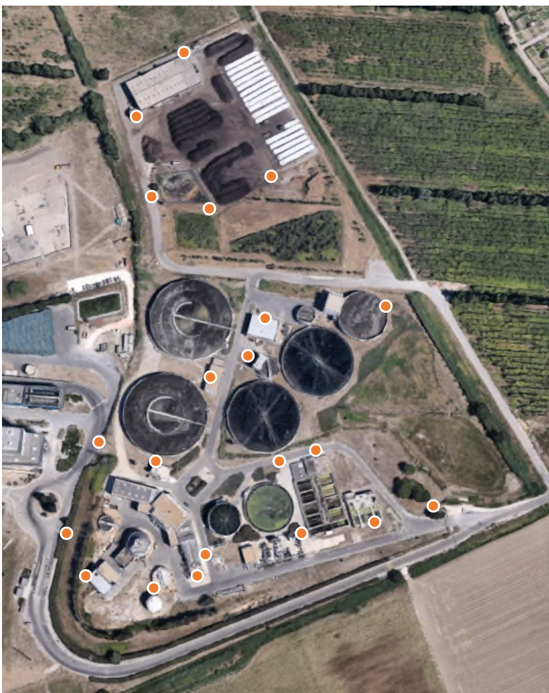
Figure 69 - Proposition de positionnement des capteurs de surveillance de la qualité de l'air
