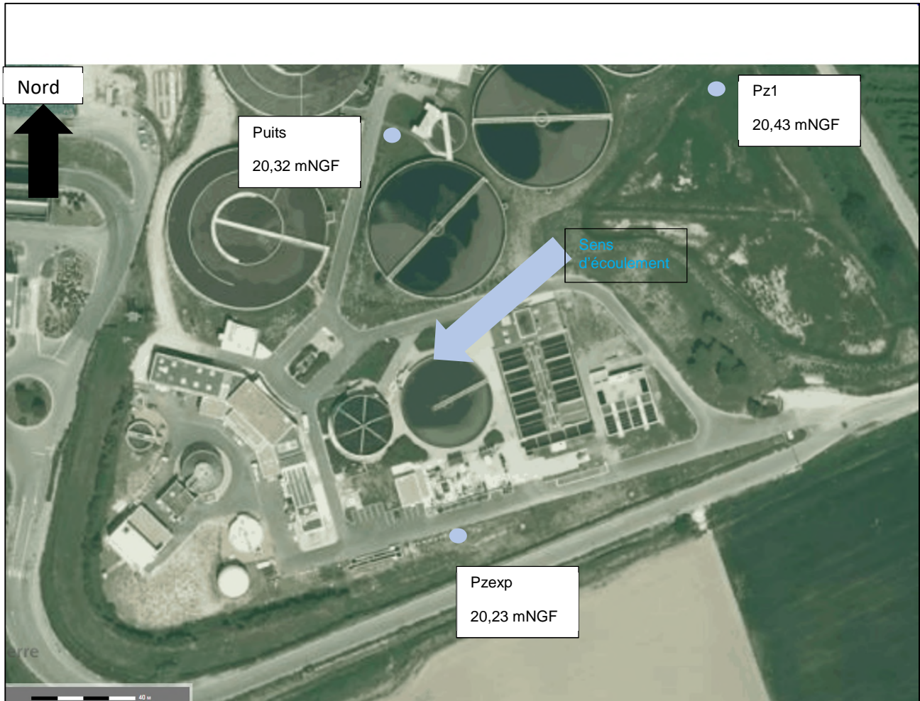
Figure 12 - Localisation des piézomètres et mesures piézométriques réalisées le 2 juillet 2019
