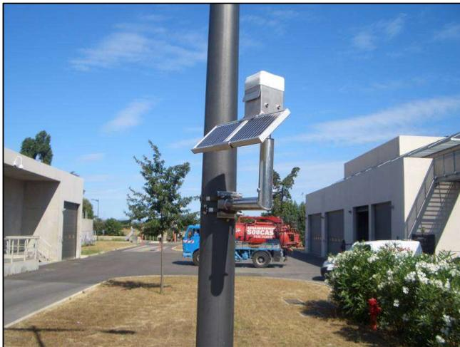
Figure 7 - Exemple de capteur H<sub>2</sub>S et de son alimentation solaire
